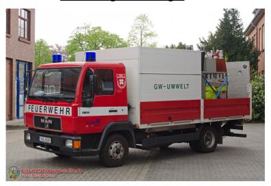
**Fahrgestell:** MAN 8.163 LC **Aufbau:** Eigenausbau
